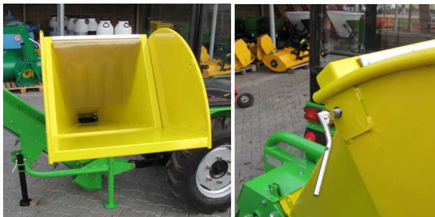
Sklopení II. části plnicího žlabu a zajištění
