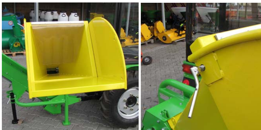
Sklopení II. části plnicího žlabu a zajištění
