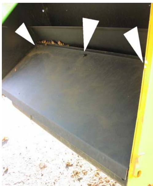
šipky vyznačují matky upevňující odklápěcí desku
