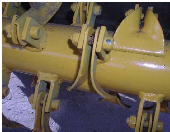
detail uložení nože (kladiva)
