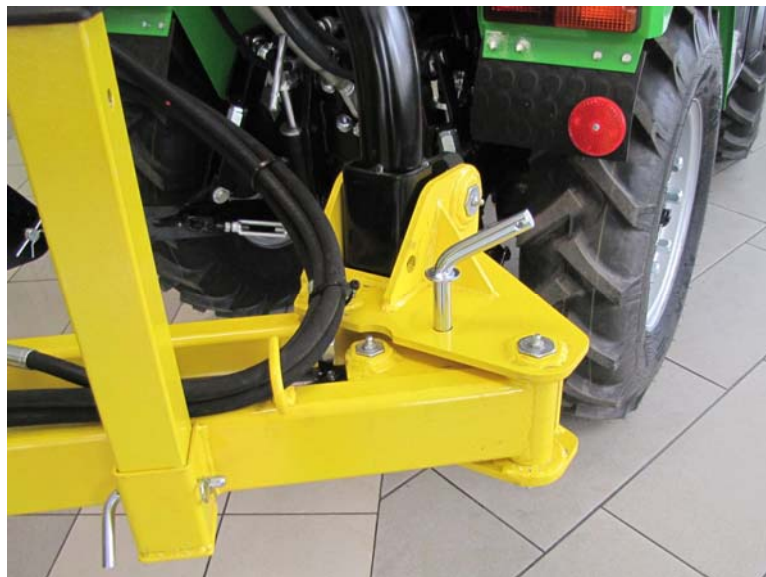
Zajištění výklopných ramen v přepravní poloze
