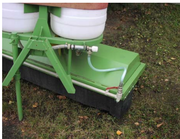
Regulace vody 1-regulační kohout, 2 - uzavírací ventil
