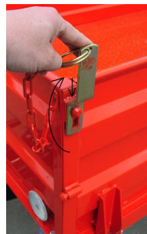
Zajištěná bočnice a její otevírání
