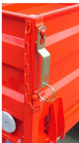
Zajištěná bočnice a její otevírání
