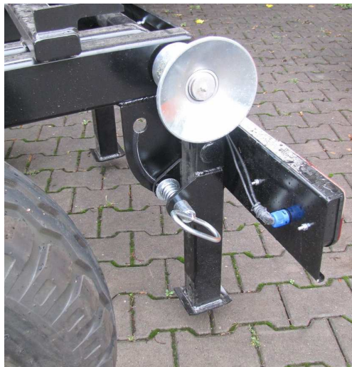
sklopná opěra v odkládací poloze
