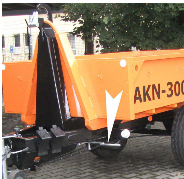
páka přepínání sklápění - odkládání
