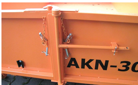
zavřené a zajištěné zadní čelo proti otevření
