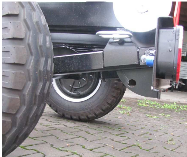
sklopná opěra v přepravní poloze
