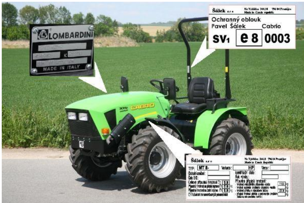
umístění štítků u provedení s ochranným rámem pozn. pro přístup ke štítkům je zapotřebí vyklopit kapotu.
