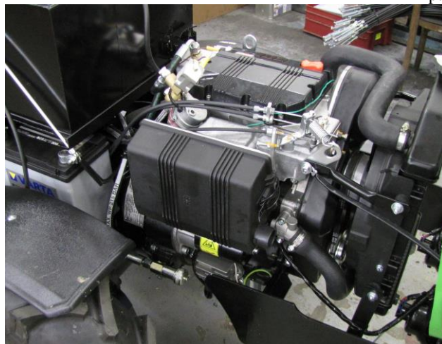
Vzduchový filtr plochý - filtr sání s suchou vložkou – mění se celá vložka
