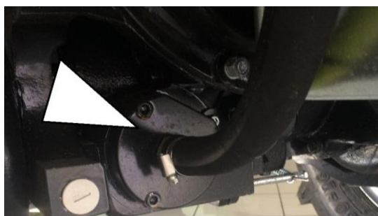
hydraulický filtr – mění se vložená patrona
