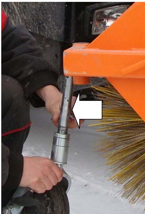
Namazání svislé hřídele otáčení kola, potření tukem lehce na povrchu
