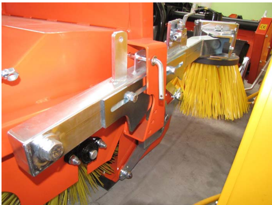
Zvednutí přimetacího kartáče do horní polohy a zajištění čepem
