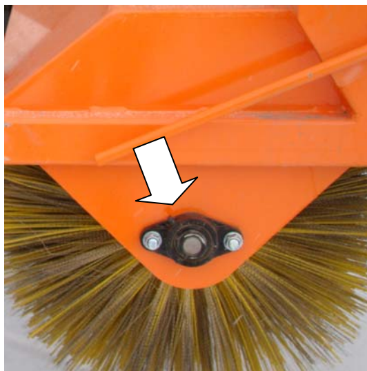
Maznice na hřídeli uložení rotoru kartáče 2x zdvih lisu
