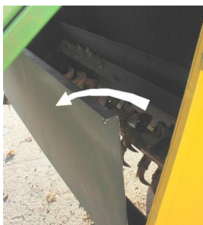
odklopení desky, s následným přístupem k šroubům, které upevňují opěrný válec
