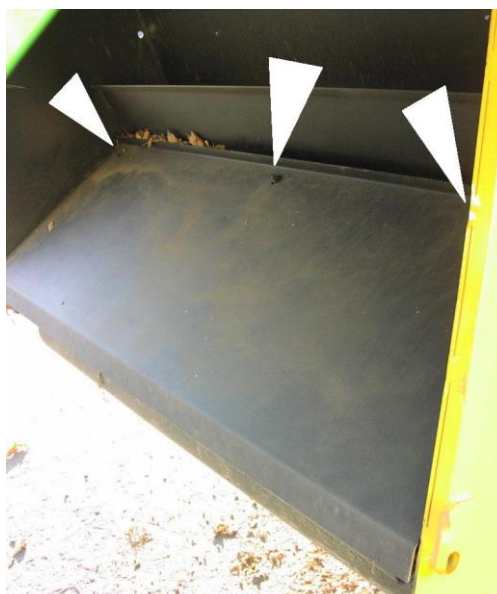
šipky vyznačují matky upevňující odklápěcí desku
