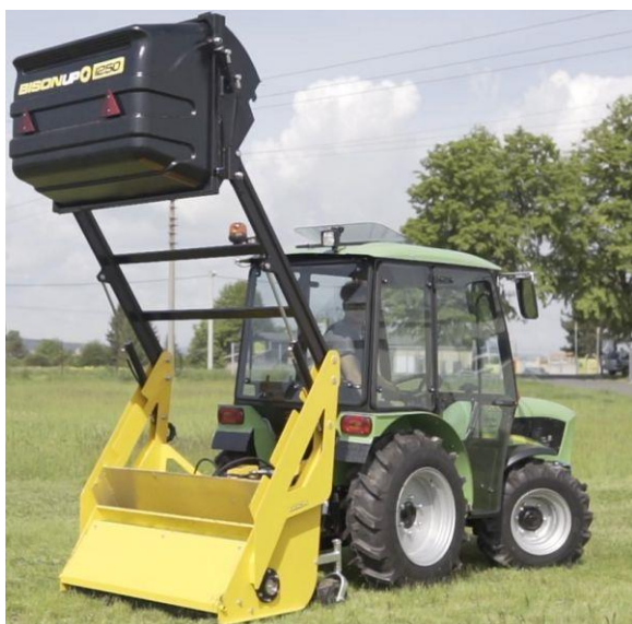
Otevření a zajištění ramen sběracího koše
