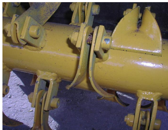
detail uložení nože (kladiva)
