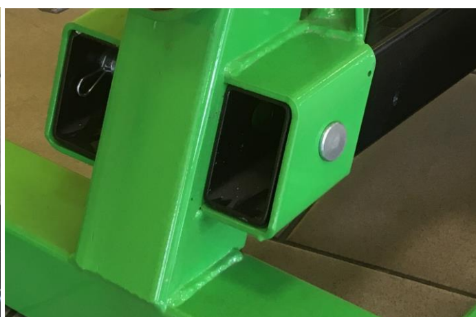
Uložení opěrného stolu v při štípání špalků
