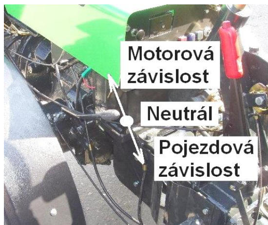
Zapínání závislosti PTO u jednokardanového provedení traktoru
