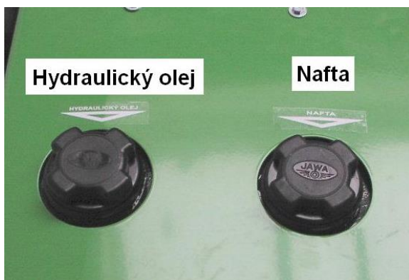
Nádrže na hydraulický olej a motorovou naftu na kapotě motoru
