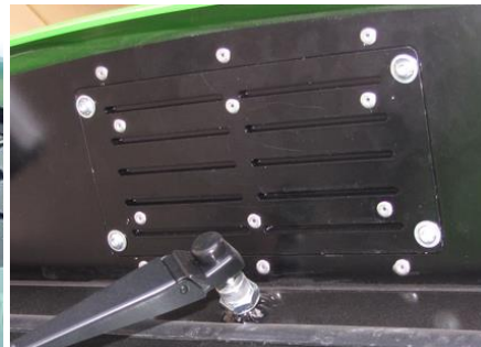
Pro přístup k filtru je nutné vyšroubovat 4 šrouby
