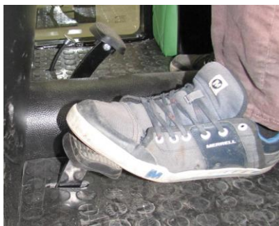
Poloviční zdvih – vypnutí pojezdu, pohon PTO zůstává v činnosti
