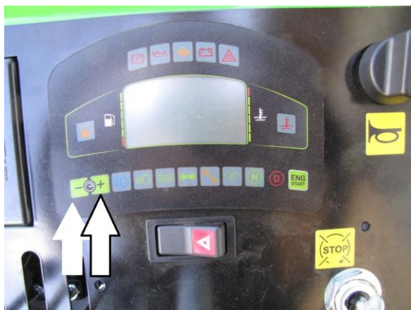
Tlačítka pro zvyšování a snižování otáček a spínací klíček pro zastavení chodu motoru
