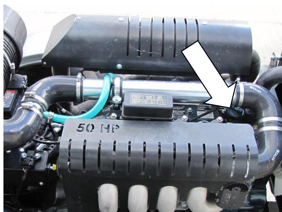
Plnicí zátka motorového oleje
