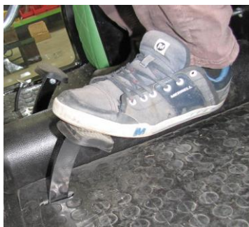
Uvolněná spojka, umožňuje pojezd i pohon PTO
