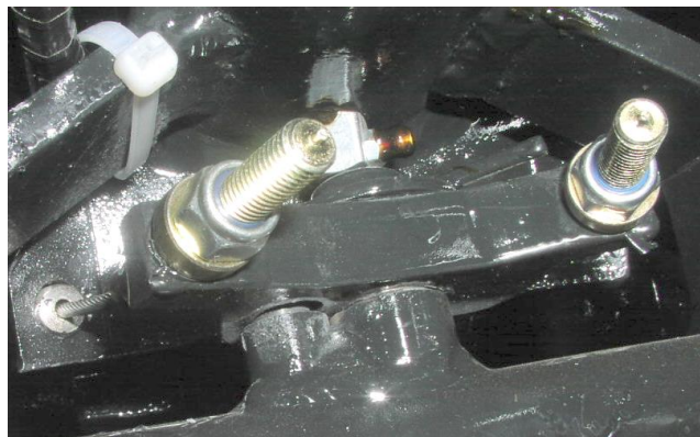
vahadlo pod převodovkou, lanka na jednotlivá kola
