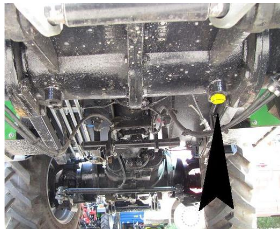
vypouštěcí šroub zadní převodovky
