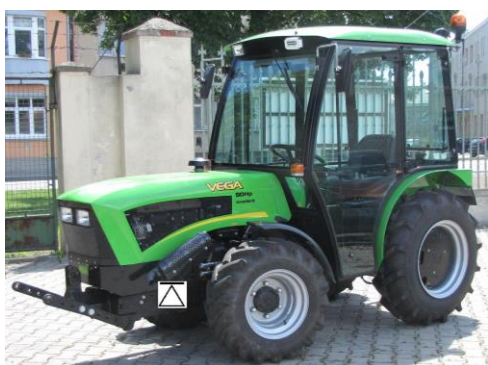
umístění zvedáku v přední části traktoru pod převodové skříně koncových převodů
