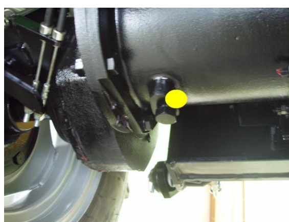
vypouštěcí otvor převodovky zadní převodovky
