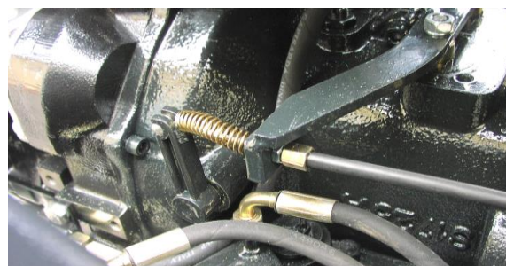
stavěcí šroub s matkou za páčkou spojkového ložiska
