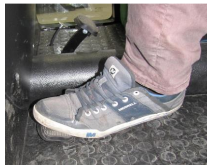
Plně vyšlápnutí spojky – úplné přerušování točivého momentu
