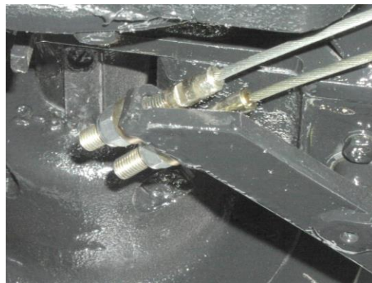
brzdový klíč, uložení provozní a parkovací brzdy
