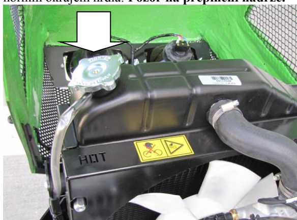
Plnicí zátka chladiče na chladicí kapalinu
