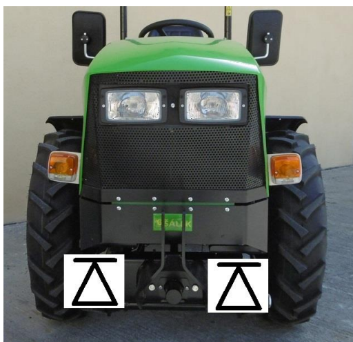
umístění zvedáku v přední části traktoru pod převodové skříně koncových převodů
