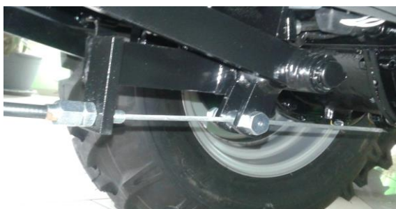
zavěšení lanka na spojkový pedál a zajištění svěrkou
