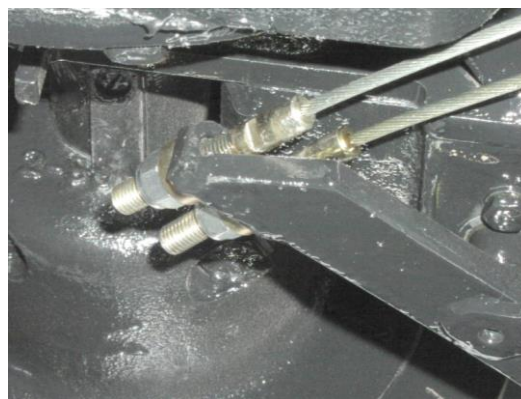
brzdový klíč, uložení provozní a parkovací brzdy
