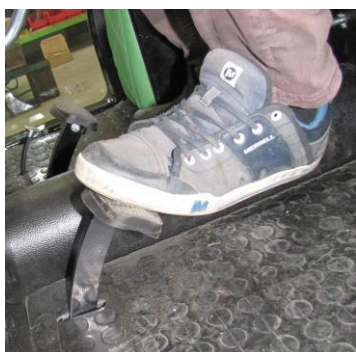
Uvolněná spojka, umožňuje pojezd i pohon PTO
