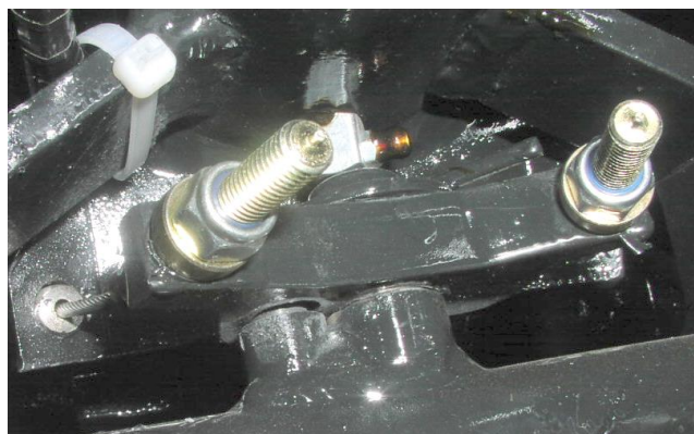
vahadlo pod převodovkou, lanka na jednotlivá kola
